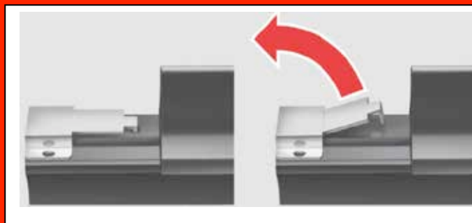
2. Levantar o gancho de fixação
