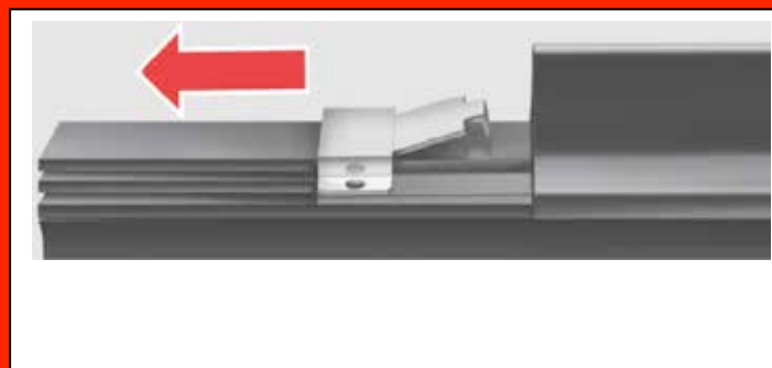
3. Retirar a borracha antiga da armação
