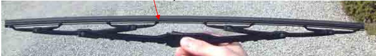
1. Staru guminicu kliještim odstraniti iz metalnog okvira, metalne šipke izvući iz okvira brisača.
